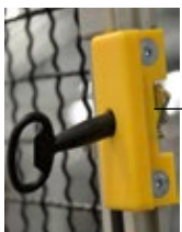
Öffnung des SE-Feld mittels Spezialschlüssel
