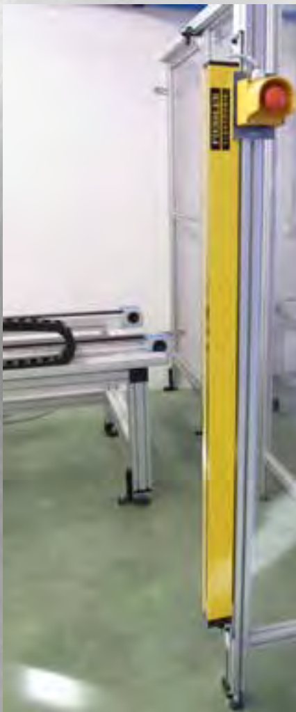
Beispiel 2-strahlige normgerechte Zugangsicherung / Bereichsabsicherung mit ULVT 500/2
